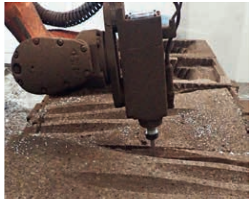
Investigação no DFL, Digital Fabrication Lab sobre a integração de processos de desenho digital e de fabricação digital para imaginar e produzir soluções em cortiça de forma personalizada. [Foto: DFL]
